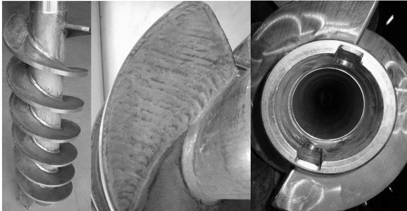
Abb.13-11: Schnecke mit gepanzertem Spezialwerkstoff und Nabenaufnahme, Neuzustand
