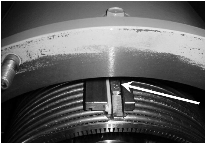
Abb.13-9 Einbauposition des Siebes, eingeschlagenes Dreieck oben und nach vorn zum Separator
